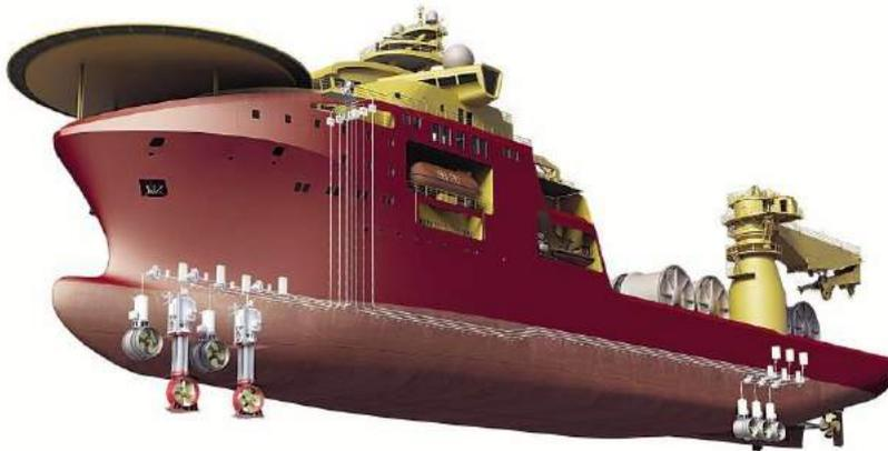
Bild 1: Quersteueranlage
